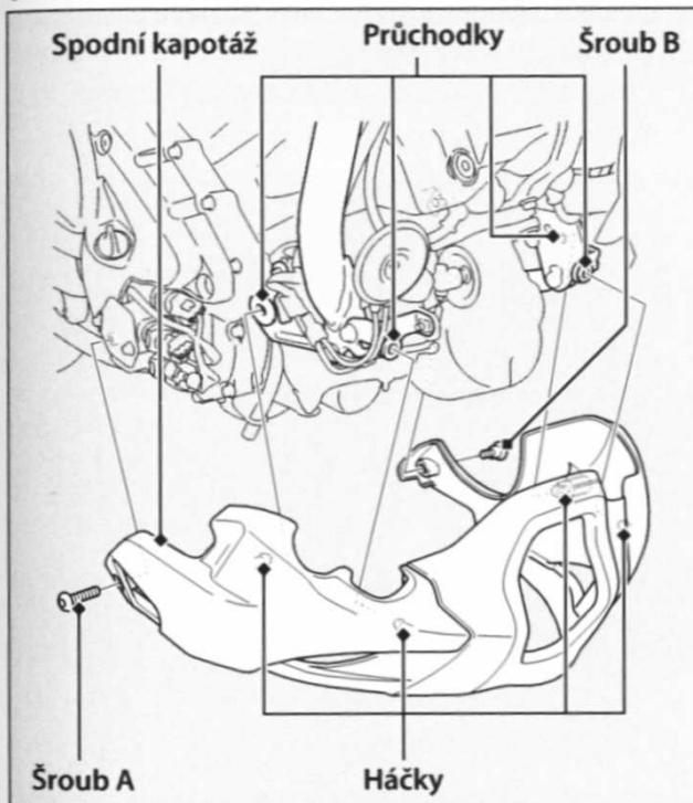
Spodní kapotáž je nutné demontovat pro přístup k expanzní nádržce chladicí kapaliny a při výměně filtru motorového oleje a olejového filtru spojky.
