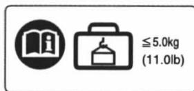
**ŠTÍTEK MAXIMÁLNÍHO ZATÍŽENÍ NÁKLADEM**Nesmí překročit **5,0 kg**.
