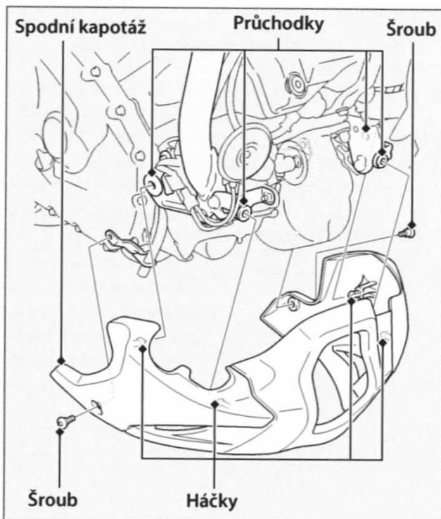
Spodní kapotáž je nutné demontovat pro přístup k expanzní nádržce chladicí kapaliny a při výměně filtru motorového oleje.
